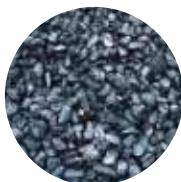
Granularni antracit odabire se po veličini čestica, tvrdoći i čistoći za filtraciju industrijske i pitke vode. Zahvaljujući angularnom obliku, antracit ima visoku filtersku učinkovitost koja omogućava visoke brzine filtracije i dulji rad filtera. Antracit se može koristiti sam ili u multimedijskim filterima.
