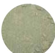
Zeleni pjesak je filterski materijal koji se koristi za uklanjanje željeza, mangana, vodikovog sulfida, arsena i radija iz vode. Jezgra materijala je od silicijevog oksida, a površina materijala je od manganovog dioksida koji djeluje kao katalizator za oksidaciju – redukciju željeza i mangana. Može se koristiti na dva različita načina rada, kontinuirana regeneracija i diskontinuirana regeneracija.
