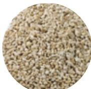
Kvarcni pjesak je najrašireniji i najupotrebljavаниji filtracijski materijal. Filtracijski mediji sastoje se od više slojeva kvarcnog pjeska koji se razlikuju po veličini čestica. Za kvalitetu filtracijskog procesa vrlo je bitna granulometrijska ispravnost filtra. Na taj način postižu se veći učinci separacije suspendiranih tvari, duži radni period između dva pranja, veći kapacitet filtra i manji pad tlaka preko filterske ispune.
