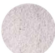
Kalcit je po sastavu kalcijev karbonat koji se koristi za neutralizaciju vode s niskim pH. Kisela voda polagano otapa kalcijev karbonat pri čemu raste pH vrijednost i sprečava otapanje bakra, olova i drugih metala u cjevovodu. Prednost kalcita je da pH vrijednost dovodi u nekorozivno područje. Kalcit također podiže tvrdoću vode.
