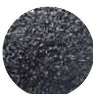
Aktivni ugljeni proizvode se za veliki niz aplikacija; od uklanjanja klora do uklanjanja organskih tvari otopljenih u vodi, što za pitku, što za industrijsku vodu. Mogu biti na bazi mineralnih i organskih tvari. Ovisno o termalnom aktivacijskom procesu pri točno kontroliranoj temperaturi dobiva se površina i struktura pora koja omogućava apsorpciju bilo male ili velike molekularne mase. Aktivni ugljeni imaju visoku gustoću i otpornost.
