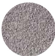
Filter Ag je silicijev dioksid koji se koristi kao visoko efektivni filterski materijal za uklanjanje suspendiranih tvari. Nepravilna površina i oštri rubovi osiguravaju veliku površinu za uspješnu filtraciju. Mala gustoća zahtijeva niže brzine povratnog pranja od ostalih filterskih materijala.
