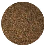
GFH je adsorbent za selektivno uklanjanje arsena (arsenita i arsenata), fosfata, selena i ostalih teških metala iz vode. Predoksidacija nije potrebna za uklanjanje arsena. Nakon zasićenja adsorpcijskog kapaciteta, masa se mora zamijeniti novom.
