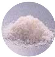
Crystal right je zeolit koji se koristi za uklanjanje željeza, mangana, tvrdoće i amonijaka iz vode. Također podiže pH vrijednost kiselih voda i tako smanjuje njihova korozivna svojstva. Crystal right ima izvrsne filtracijske karakteristike. Regenerira se otopinom soli.
