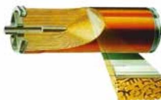
Karakteristično za ovaj proces je da se strujanje obavlja paralelno s membranom, a ne okomito na nju. Permeat, ili dobivena pročišćena voda, prolazi kroz membranu dok otopljene krute tvari, čestice i organske tvari ne mogu proći kroz membranu već se odvođe u odvod kao koncentrat ili otpadna voda.
